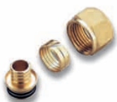
Logafix Klemmverschraubung aus Messing mit Eurokonus 3/4"
