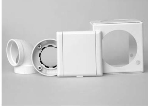
Das Aufputzgehäuse an der gewählten Stelle ausrichten und die Bohrungen durch das Gehäuse mit einem Bleistift übertragen. Gehäuse an der Wand befestigen. Die Befestigungslasche vom Montagerahmen abbrechen. Den Montagerahmen mit dem 90° Bogen -kurz- verkleben.
