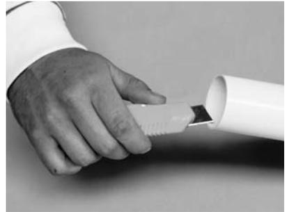
Bevor Sie das Rohr mit einem Fitting (Bogen etc.) ankleben, müssen beide Klebeflächen frei von Schmutz und Staub sein.
