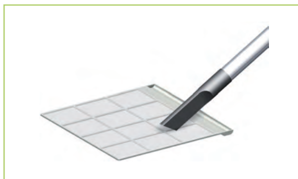
Abb. 49: Reinigung mit dem Staubsauger
