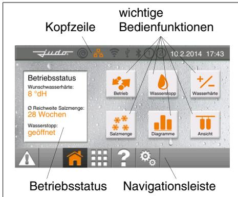
Abb. 10: Home-Ansicht der Wasserenthärtungsanlage
